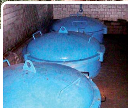
Ve štolě Kristýna pod ochrannými zvony pracují tři seismometry
