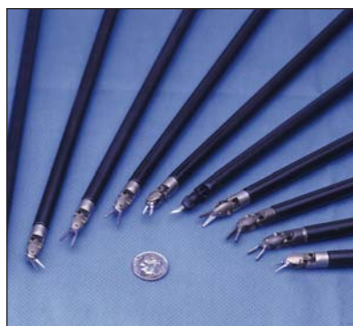
MINIATURNÍ KONCOVKY RUKOU robota se vybírají podle druhu operace
